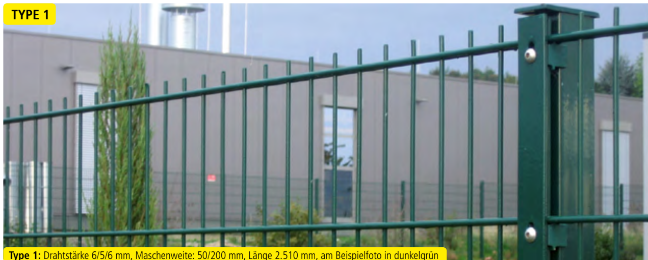
Type 1: Drahtstärke 6/5/6 mm, Maschenweite: 50/200 mm, Länge 2.510 mm, am Beispielfoto in dunkelgrün
