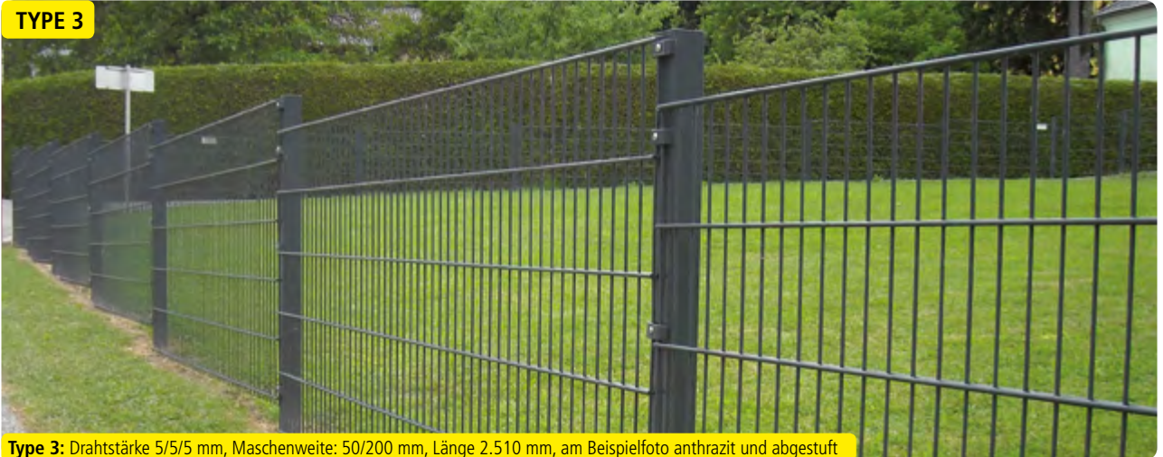
Type 3: Drahtstärke 5/5/5 mm, Maschenweite: 50/200 mm, Länge 2.510 mm, am Beispielfoto anthrazit und abgestuft
